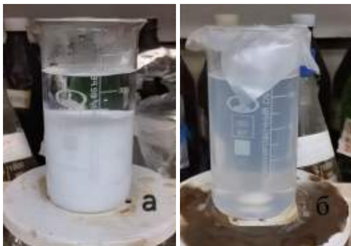
Рисунок 22 – Раствор после добавление водного раствора аммиака: (а) сразу после добавления 30 мл; (б) после 10 минут
