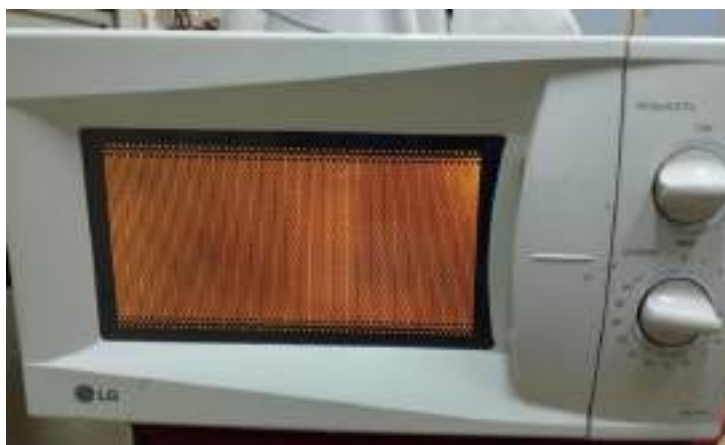
Рисунок 23 – Нагревание раствора в микроволновой печи LG MS 1924x при мощности 350 Вт
