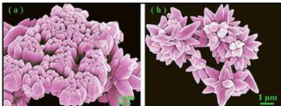
Рисунок 15 – СЭМ изображение порошков ZnO полученные в микроволновой печи (а) при 10 мин, (б) при 15 мин [98]
